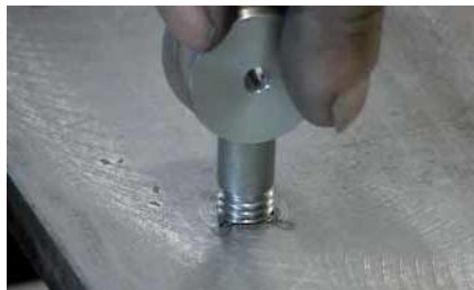
5. Gewindebolzen eindrehen, 7 mm mit Hilfe Bit oder Treppentopf eindrehen
