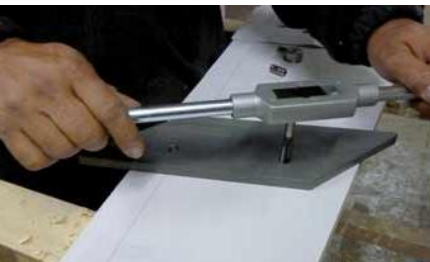
4. Gewinde M12 schneiden min. 8 mm tief.
