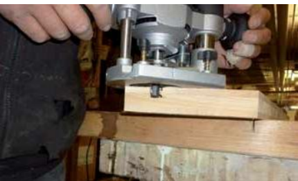
7. Mit einer Oberfräße wird der seitliche Durchbruch für den Gewindebolzen min.13mm breit und 13mm tief gefräßt.
