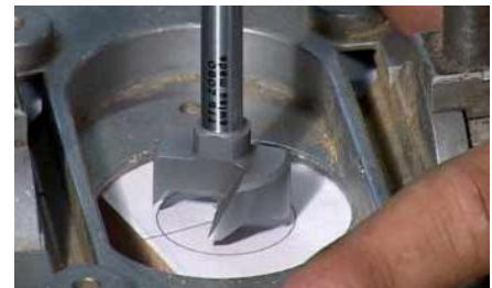
6. Holzstufe mit Forstnerbohrer Durchmesser 30 mm, 13 mm tief bohren und reinigen. Bei Verwendung einer 3,0 mm starken Dämmscheibe 15,5 mm tief bohren. Die Dämmscheibe sollte ca 0,5 mm unter Spannung sein.
