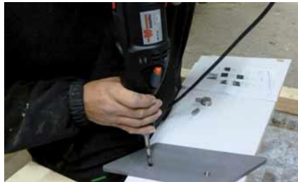
2. In die Stahlwangen Sackloch für Gewinde M12 bohren. Min. 8 mm tief oder Durchgangsloch.
